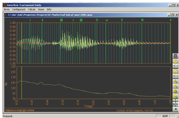
Figura 2: Ejemplo de funcionamiento de ITP. Se presentan distintas informaciones: las marcas de segmentación, las de pitch, la transcripción fonética y la curva de pitch.
